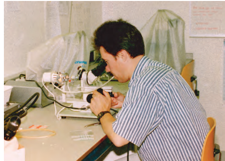
John Dumoulin probeert m.b.v. een microforge het juiste bochtje in een ICSI pipet te maken. IVF-laboratorium azM Maastricht anno 1994
